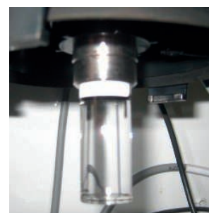
Figure 3 : photo du flacon au terme des 109 jours de test avec nettoyant en fibre. Le flacon semblait complètement propre après le test. Plusieurs autres contrôles du flacon effectués au cours du test indiquaient que la propreté était constante. A vrai dire, le flacon (qui a été installé sur cet instrument en octobre 2016), fonctionnait sur une période de temps beaucoup plus longue dans cette application avec l'ACM.
